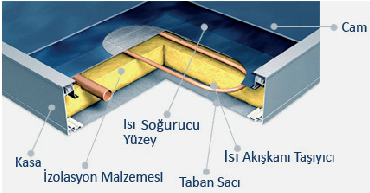
Şekil 7.3. Düzlemsel Güneş Kolektör Kesiti
