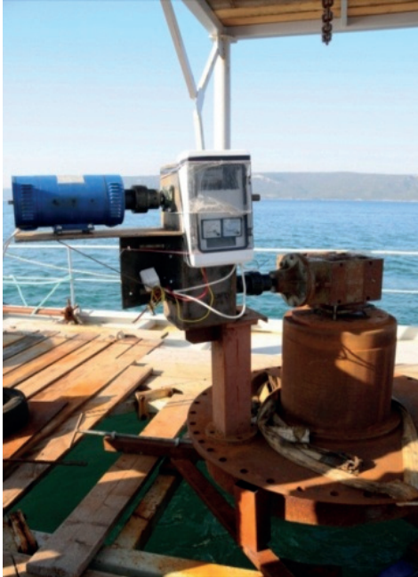
Şekil 10.13. Katamaran, Tahrik Mili, Dişli Grubu, Alternatör, Sabit Yük, Silindir Tabla ve Ölçüm Grubu (Özgün)
